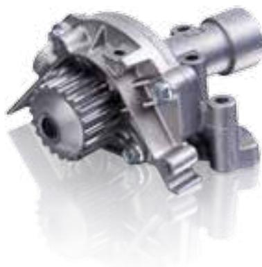
Molte pompe acqua sono azionate dalla cinghia di distribuzione. Se la pompa acqua si guasta, il refrigerante fuoriesce sporcando la cinghia, e al lungo andare, provoca la rottura prematura della cinghia di distribuzione. Gates consiglia la sostituzione della pompa acqua azionata dalla cinghia di distribuzione e degli altri componenti della trasmissione.
