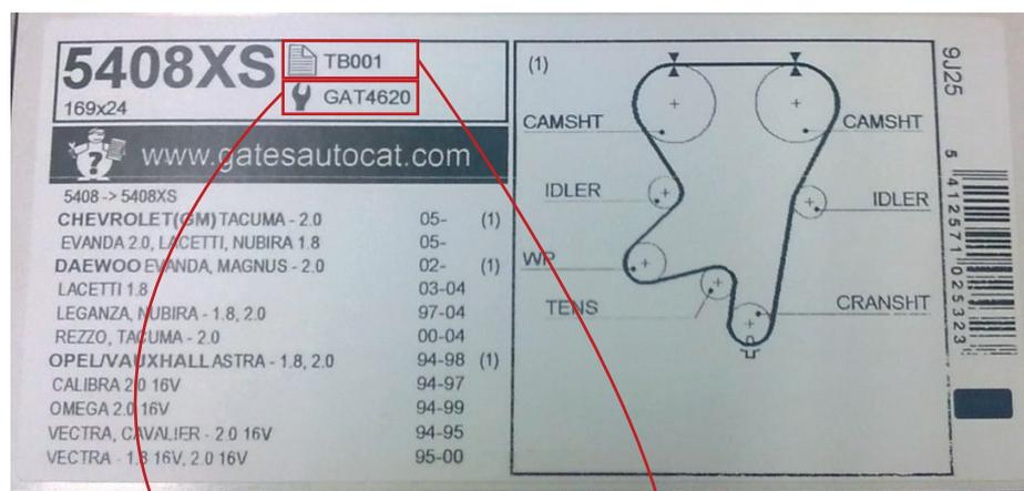
Para instalar correctamente la correa 5408XS, necesitaremos la herramienta del kit de distribución GAT4620, y en el boletín técnico 001 (TB001) podremos encontrar consejos e instrucciones sobre la instalación de este sistema de transmisión.
