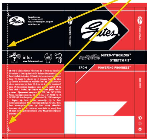
La STF (herramienta Stretch Fit™) correcta se indica en la parte posterior de la funda en la generación Horizon y en la parte frontal en la generación anterior. El procedimiento de instalación incluido dentro de la funda también repite cuál es la herramienta correcta que debe usarse con esta aplicación.
