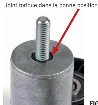
Les boulons de ce tendeur doivent être serrés à 25 Nm. Pour ne pas influencer le couple du boulon central, s'assurer que le joint torique est installé correctement dans la position prévue. (Fig. 6)
