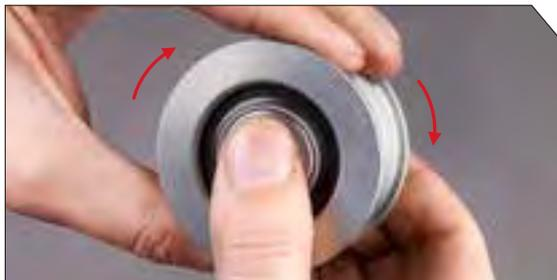
› **Test 1:** A l'aide de l'index et du pouce, maintenez en place la bague intérieure (axe). De l'autre main, faites tourner la bague extérieure dans le sens de la courroie. Si la bague extérieure bouge, vous devez remplacer l'OAP.
