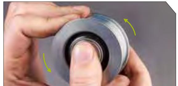
› **Test 2:** Maintenez la bague intérieure (axe) de sorte qu'elle ne puisse pas bouger. Faites tourner la bague extérieure dans le sens opposé à la courroie. Vous ressentirez probablement une légère résistance, mais la bague extérieure devrait tourner avec souplesse. Si ce n'est pas le cas, remplacez l'OAP.
