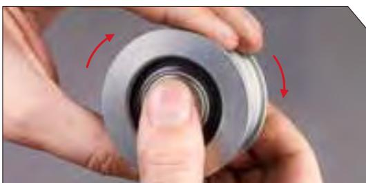
› **Test 1:** Utilizzare il dito indice e il pollice per tenere in posizione l'anello interno (albero). Ruotare l'anello esterno con l'altra mano, nella stessa direzione della cinghia. Se l'anello esterno di sposta, è necessario sostituire l'OAP.
