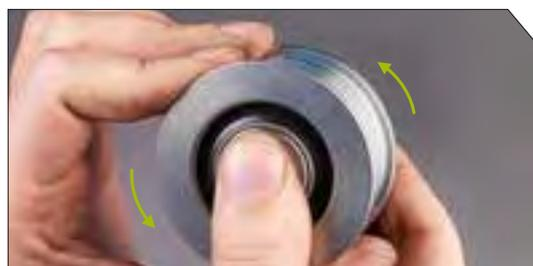
› **Test 2:** Tenere l'anello interno (albero) in modo che non si muova. Ruotare l'anello esterno in direzione opposta rispetto a quella della cinghia. Probabilmente, si avvertirà una certa resistenza, ma l'anello esterno dovrebbe ruotare correttamente. In caso contrario, sostituire l'OAP.
