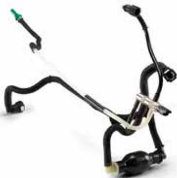
Les tuyaux de carburant moulés permettent la circulation depuis le réservoir jusqu'aux injecteurs, mais sont soumis aux variations du système basse et haute pression qui peuvent fragiliser le caoutchouc. Ils sont équipés de connecteurs en plastique qui peuvent devenir défectueux avec le temps et l'exposition à la chaleur.
