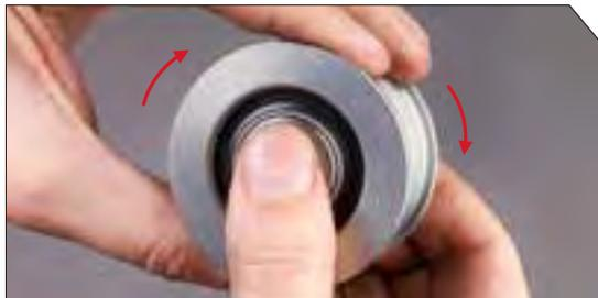
› **1ª prueba:** Utilice el dedo índice y el pulgar para sujetar el anillo interior [eje] en su sitio. Gire el anillo exterior con la otra mano en la misma dirección que lo haría la correa. Si el anillo exterior se mueve, tiene que sustituir la OAP.
