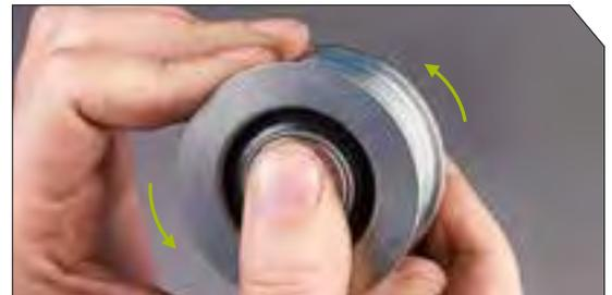
› **2ª prueba:** Sujete el anillo interno [eje] para que no se mueva. Gire el anillo exterior en la dirección contraria a la correa. Probablemente note una pequeña resistencia, pero el anillo exterior debería girar suavemente. Si no lo hace, sustituya la OAP.
